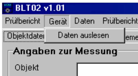
Bevor ein Prüfbericht erstellen werden kann, müssen aus dem blowtest® die gespeicherten Messungen auslesen werden.
